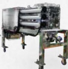
自动除铁器 Automatic Magnetic Filter
